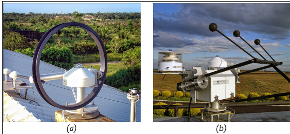
Figura 2.21: Sistemas para sombreamento do piranômetro utilizados na aquisição de dados de radiação difusa: anel de sombreamento (a) e esfera de sombreamento com rastreador solar (b).
