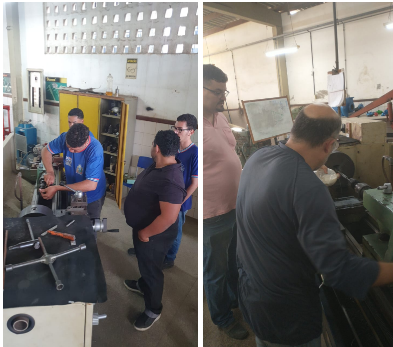
Figura 4.36: Fabricação de peças para acoplamento do motor a base do seguidor solar.
