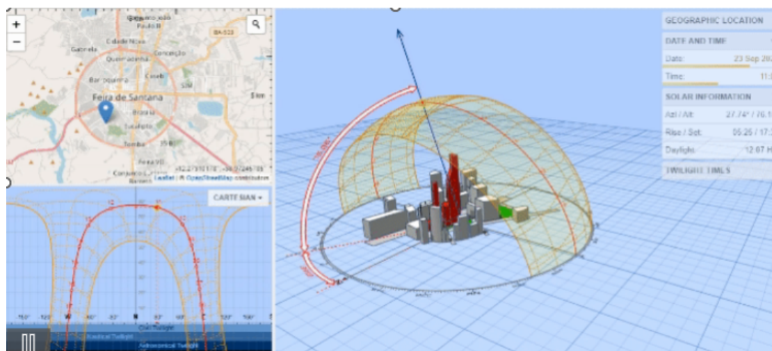
Figura 2.9: Trajetória Solar no applet 3D Sun Path para localização na Cidade de Feira de Santana-BA.
