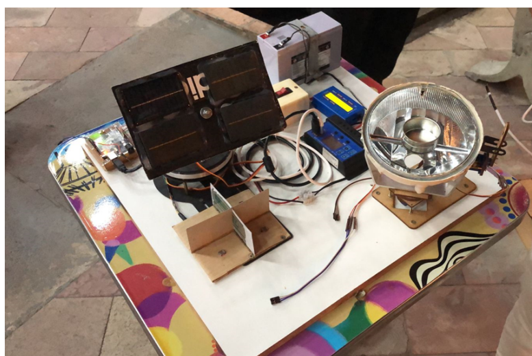
Figura 4.20: Projeto do Seguidor Solar para Painéis Fotovoltaicos e Cuba Heliotérmica.
